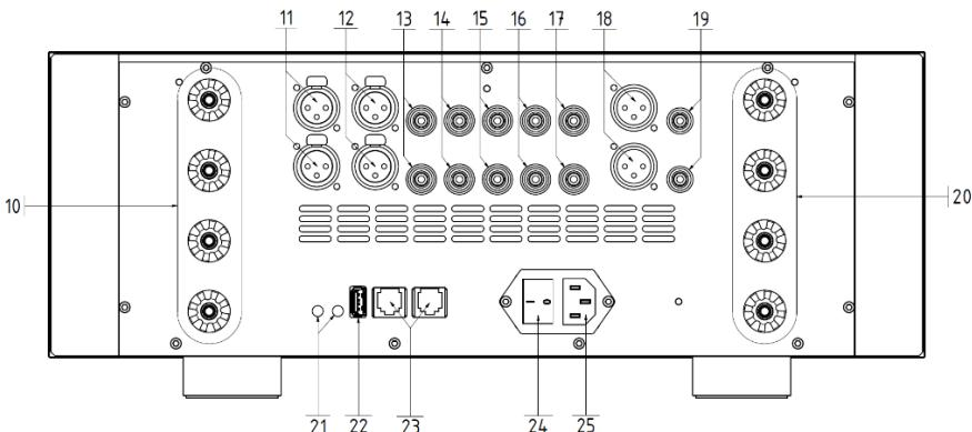
**10:** 2 Lautsprecherausgänge, **rechter Kanal**. Rote Buchse mit dem Pluspol des Lautsprechers verbinden, weiß markierte Buchse mit dem Minuspol verbinden. Durch die 4 Buchsen pro Kanal können Sie zwei Kabel pro Kanal verwenden, eines für den Bass, eines für den Mittelhochton (sofern Ihre Lautsprecherbox ein BiWiring-Terminal hat). Die beiden rot- und weiß-markierten Buchsen sind parallel geschaltet, es spielt also keine Rolle, welche Sie jeweils benutzen.
