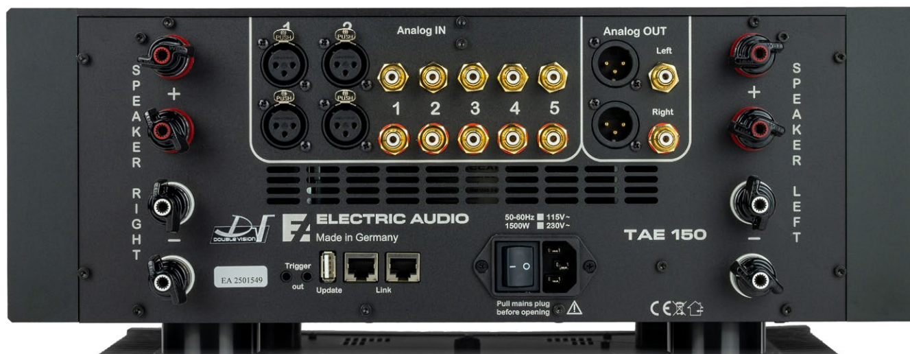
Die Rückseite ist mit fünf Cinch- und zwei XLR-Eingängen, zweifach vorhandenen Vorverstärkerausgängen, Bi-Wiring-WBT-Klemmen und Anschlüssen zur Steuerung mit dem PAE 150 reichhaltig bestückt.
